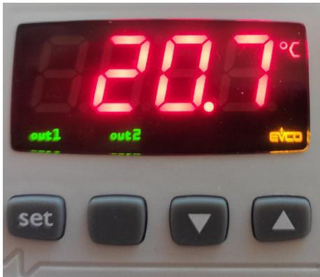
Das Display zeigt im eingeschalteten Zustand die am Fühler gemessene Temperatur an. Die Anzeige kann über den Parameter P0 auf den Betriebssollwert geändert werden.
